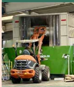
ホイローダーで原料を 攪拌機に入るところ
